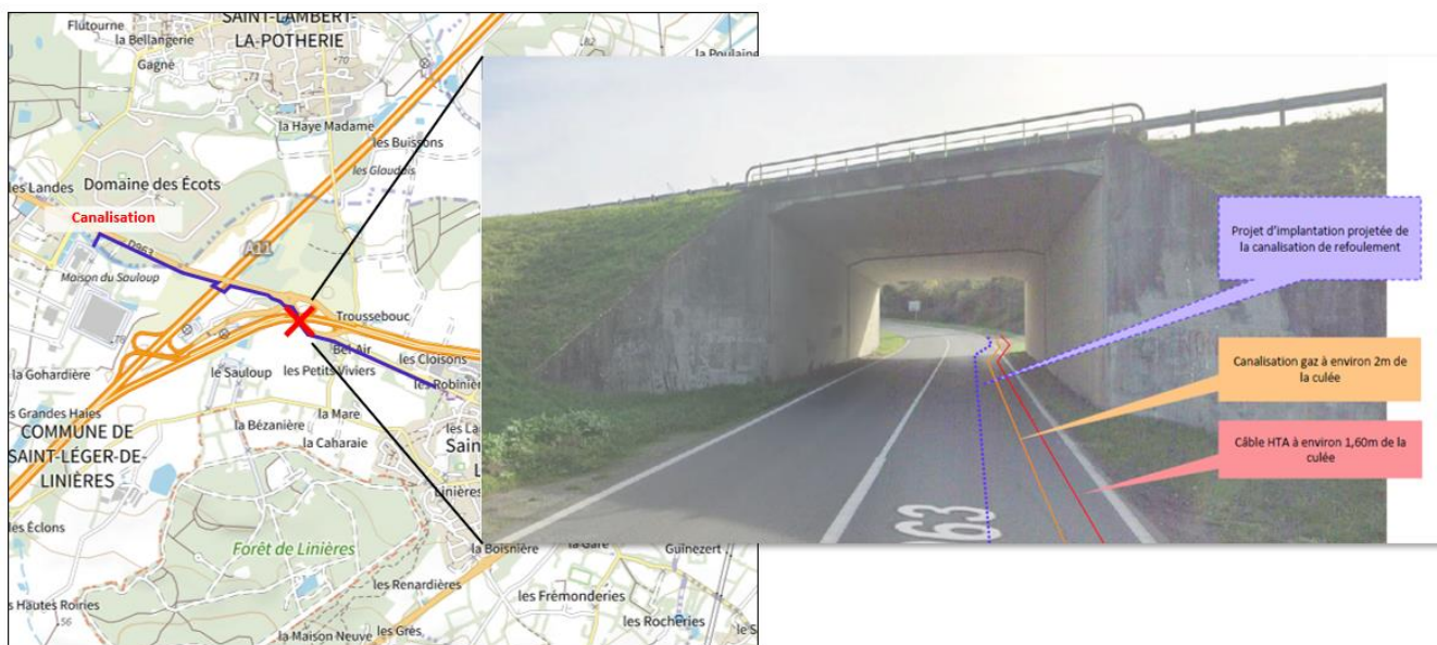
Figure 65 : Tracé de la canalisation sous le tunnel de la N323 vis à vis des réseau HT et gaz
